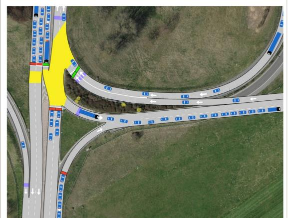
La variante du carrefour de Chassotte qui comporte 2 voies de circulation sur l'axe Givisiez-Fribourg est la plus intéressante. Elle permet de faire circuler un plus grand flux de véhicules et ainsi de limiter les congestions sur les différentes branches.
