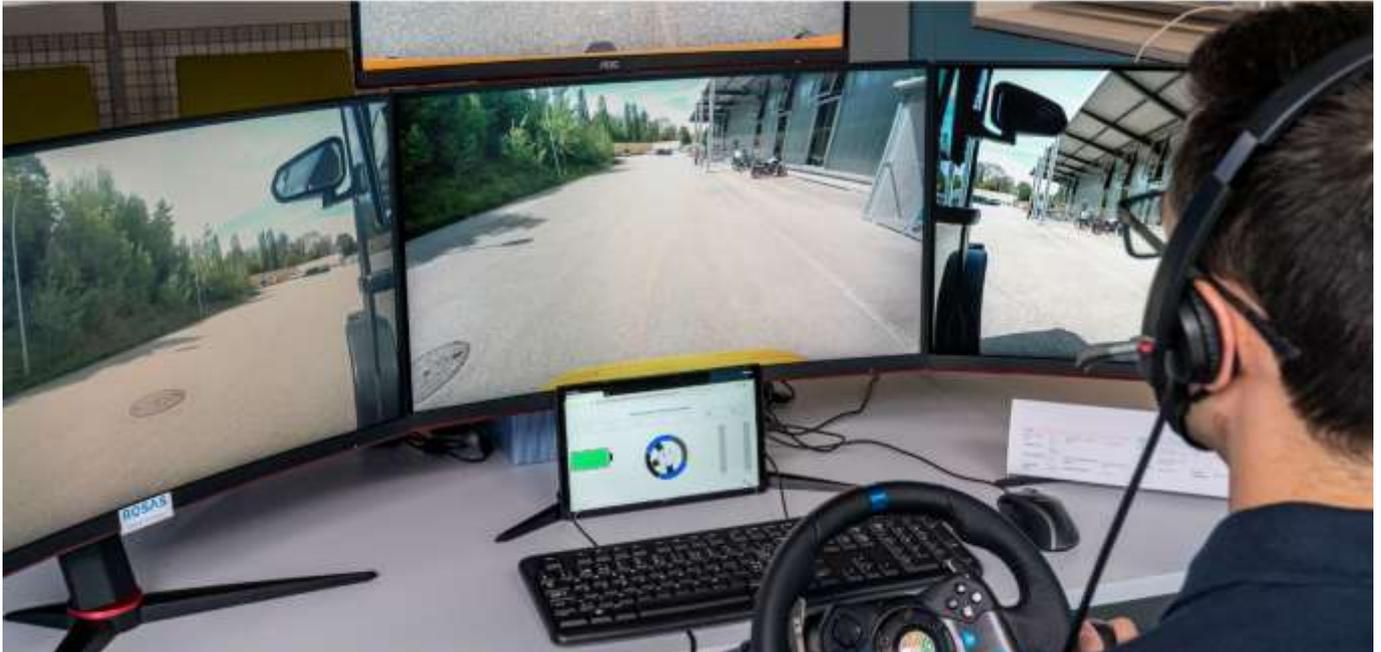
Développement et mise en place d'un concept de téléopération centralisée permettant de piloter à distance des véhicules automatisés et connectés sur la base des exigences de sûreté et de cybersécurité.
